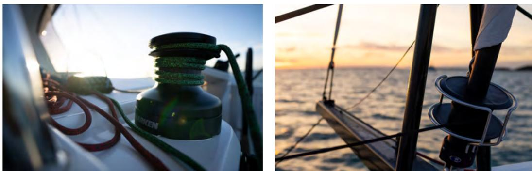
Le solent est monté sur un enrouleur PROFURL. Son rail d'écoute autovireur Harken est situé sur le roof en avant du mât. L'auto-vireur permet des manœuvres faciles et en toute sécurité.
